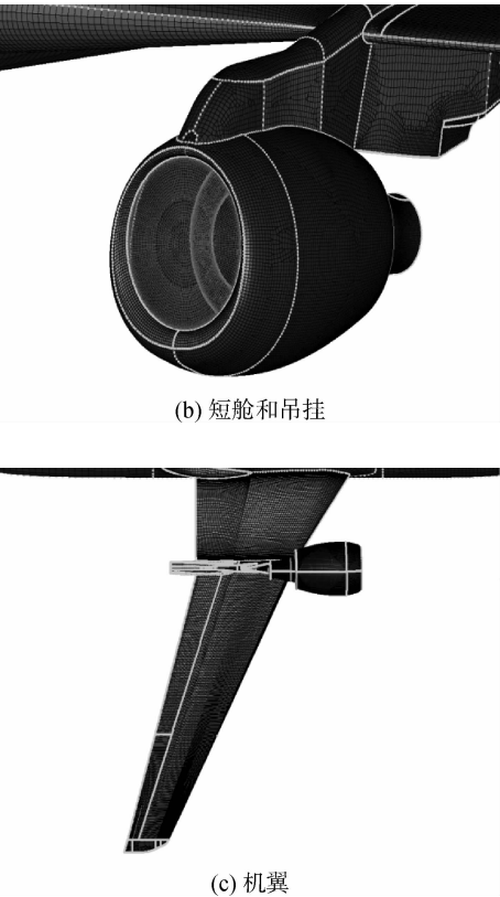
图 1 飞机表面计算网格
